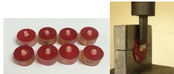
Gambar 1. Bentuk spesimen dan pengujian spesimen dengan uji kuat rekat geser.
